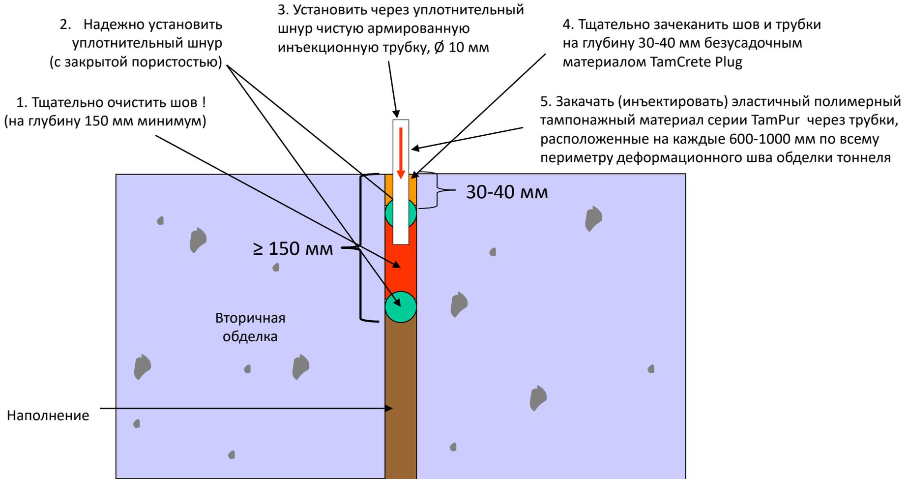
Диаметр уплотнительного шнура следует подбирать таким образом, чтобы он надежно фиксировался в шве
